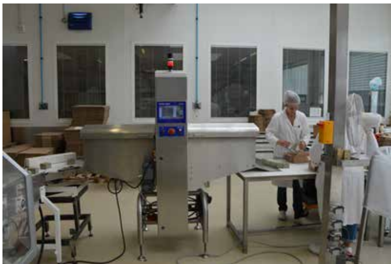
Das X33-Röntgeninspektionssystem prüft die Seife von Laboratoires BEA am Ende der Produktionslinie vor dem Versand in Länder weltweit.
