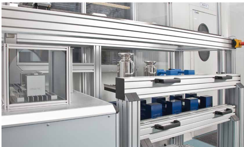
Comparador de alta carga (AX32004-M10) de METTLER TOLEDO para la determinación automatizada de la masa de las pesas de botón en caja y de empuñadura de agarre de 1 a 20 kg.
