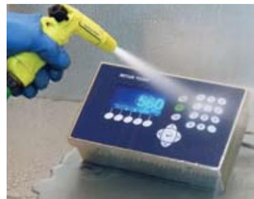
Para resistir los ambientes de las industrias farmacéutica y química, la robustez del IND560 está garantizada mediante su protección IP65 para versión panel, e IP69K para versiones pared o sobremesa. El IND560 también cumple con los requisitos de las industrias de bebidas y alimentos. La construcción en acero inoxidable 304 y su acabado pulido sanitario, son resistentes a los agentes agresivos de limpieza y cumplen con las normativas europeas EHEDG y las americanas NSF.
