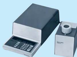
80er Jahre Mikroprozessor gesteuertes TA-System
