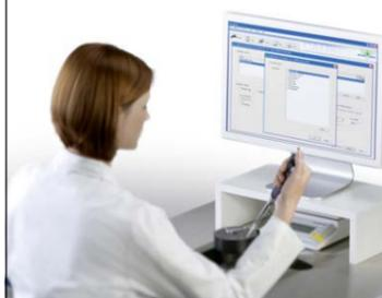
Die Waage steht bei dieser 2-in-1-Tischkonstruktion auf einem separaten Innentisch. Dies gewährleistet Vibrationsfreiheit, kürzere Stabilisierungszeiten und präzisere Daten.
