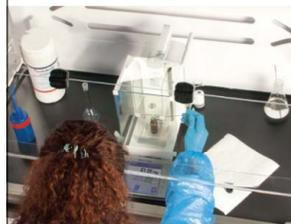
Die Konstruktion der Sicherheitskabine ist perfekt auf die Anforderungen von Analysen- und Mikrowaagen ausgelegt. Zusammen mit einem auf die Sicherheitskabine abgestimmten Wägetisch sind zuverlässige Wägeregebnisse garantiert.
