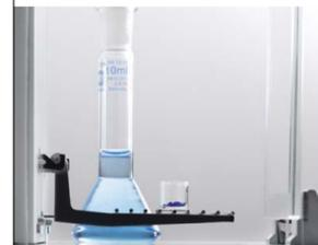
XPE-Mikroanalysenwaagen sind weltweit die einzigen mit hängender Waagschale. Dank minimaler Turbulenzen im Wägeraum wird die Einschwingzeit reduziert, sodass das Messergebnis schnell ausgegeben werden kann. Das ist besonders vorteilhaft beim Arbeiten im Abzug oder in Sicherheitswägekabinen.
