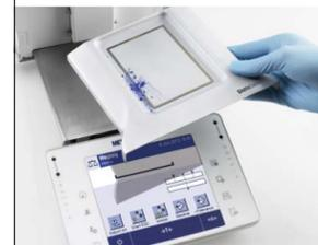
Windschutz, SmartGrid und Auffangschale können in wenigen Sekunden abgenommen und in der Spülmaschine gereinigt werden. Bei der Arbeit mit gefährlichen Proben sorgen Einwegabdeckungen für das Terminal für zusätzlichen Schutz des Bedieners. Kreuzkontaminationen können so verhindert werden.
