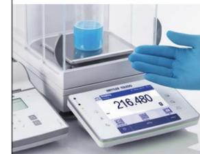
Dank des im Terminal integrierten SmartSens-Infrarotsensors lassen sich ausgewählte Wägeprozesse mit einer Handbewegung durchführen, beispielsweise Wägen, Trieren oder Ergebnisse an den Drucker senden. Die Wägevorgänge sind ergonomischer und Kreuzkontaminationen werden vermieden.
