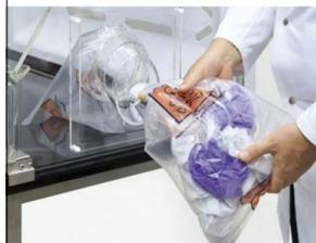
Die Keramikarbeitsfläche ist kratzfest, einfach zu reinigen und chemikalienresistent. Das integrierte Abfallbeutelsystem gewährleistet eine sichere, kontaminationsfreie Abfallentsorgung.
