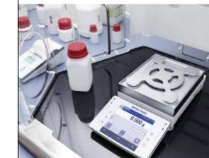
Das SmartPan minimiert eine Beeinflussung des Wägeregebnisses durch Luftströme und verbessert so deutlich Einschwingzeiten und Genauigkeit. Verschüttete Substanzen verbleiben für ein sicheres Entfernen und Reinigen in der Schale.
