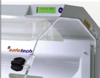
Alle Kabinen sind mit einem Alarmsystem und zwei Alarmsensoren ausgestattet. Die Sensoren messen die Strömungsgeschwindigkeit an der rechten und linken Seite der Arbeitsöffnung. Sobald die Strömungsgeschwindigkeit einen Grenzwert unterschreitet, wird sowohl ein akustischer als auch ein optischer Alarm ausgelöst.
