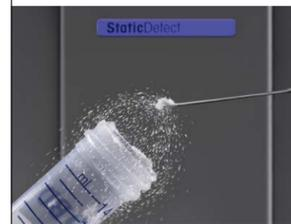
StaticDetect erkennt elektrostatisch geladene Proben und/oder Probenbehälter. Der Wägefehler wird gemessen und bei einer Überschreitung des benutzerdefinierten Grenzwerts wird eine Warnung ausgegeben. Anhand dieser Informationen können Sie dann bei Bedarf entsprechende Antistatikmaßnahmen ergreifen.
