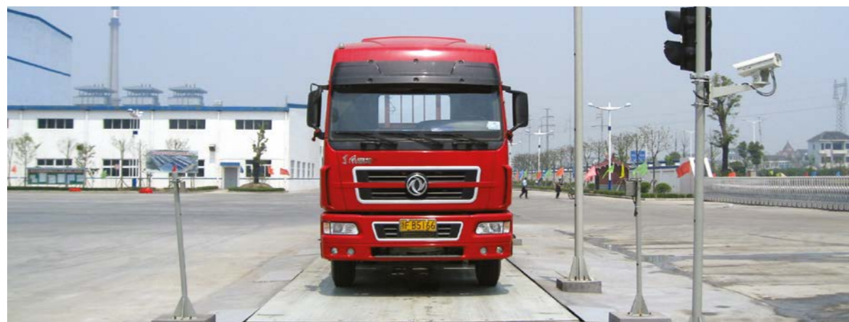
POWERCELL® GDD®-lastceller bruker avansert digital teknologi til å sikre nøyaktig kjøretøyveiling til en rimelig pris.
