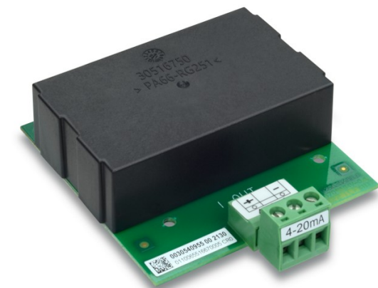
图 47: 本安型4-20mA模拟量输出接口
