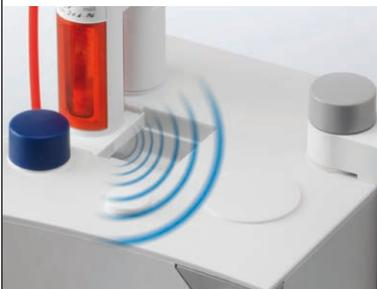
Das Titriermittel und der Sensor werden dank Plug & Play beim Anschliessen an den Titrator automatisch erkannt. Alle relevanten Daten werden auf dem Büretten- bzw. Sensor-Chip gespeichert.
