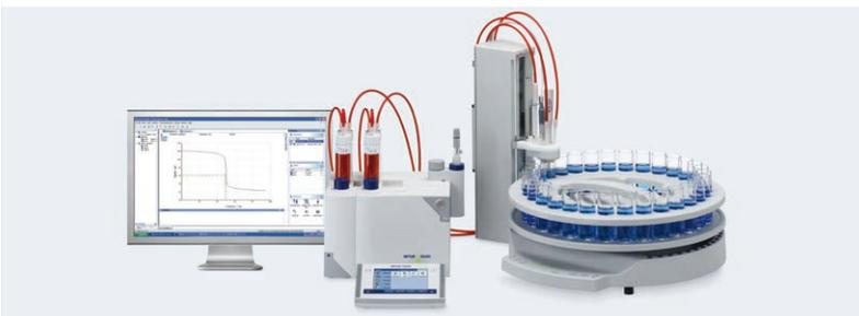
Auch die Excellence Titratoren verfügen über das intuitive One Click® Bedienkonzept. Ihr modularer Aufbau ermöglicht ein massgeschneidertes System. Dadurch können komplexe Automatisierungsprozesse einfach realisiert und mit einem einzigen Knopfdruck gestartet werden.
